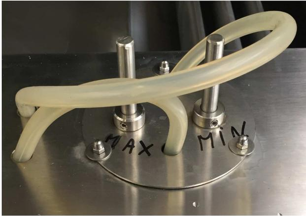
Possibilità di regolare l'altezza dei due livelli di acqua, livello minimo (MIN) e livello massimo (MAX).
