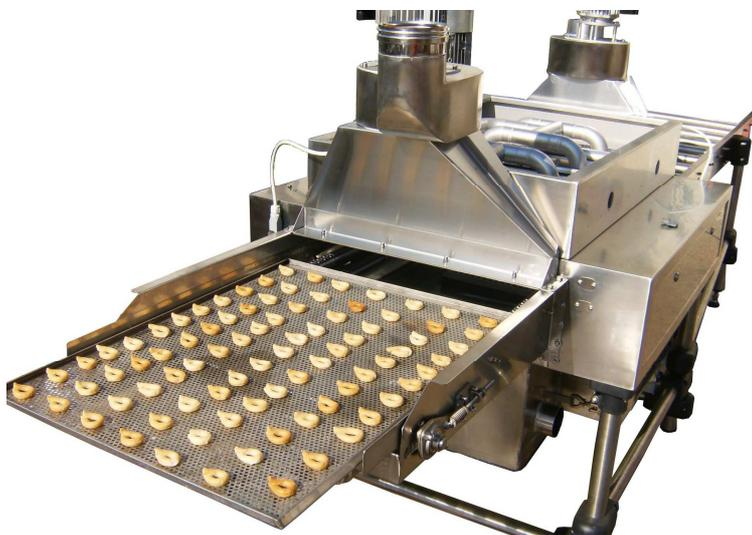
La regolazione della velocità di avanzamento della teglia (quindi il tempo di cottura del prodotto) avviene mediante la regolazione di un'apposita manopola multigiri posta in un quadro comandi separato ed indipendente.
