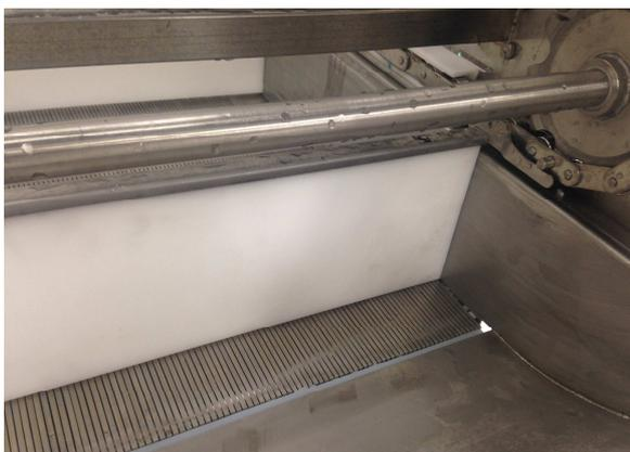
Il nastro del bollitore è diviso in due zone principali. La "zona di cottura" e la "zona di risciacquo":
