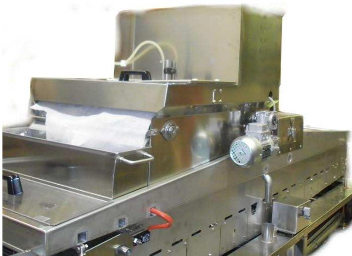
Il sistema di filtraggio assicura un'ottima pulizia dell'olio, una lunga durata ed un'estrema praticità. L'olio pompato dalla vasca della friggitrice al filtro a carta, viene filtrato da una speciale carta per alimenti (indicata per l'utilizzo fino alla temperatura di 200°C) che trattiene i residui di cottura, la farina, e le piccole particelle, lasciando passare l'olio pulito, che per caduta ritorna, a scelta, nella vasca della friggitrice o nella vasca di rabbocco dell'olio.
