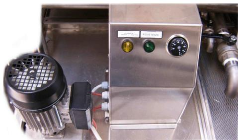
Carico dell'olio nella friggitrice in modo automatico (comandato dai livelli MAX e MIN) o manuale. Se il livello dell'olio supera quello impostato, il troppopieno scarica l'olio in eccesso nella vasca di recupero. Mantenimento di una certa temperatura tramite delle resistenze nella vasca di rabbocco in modo che l'olio non si solidifichi.
