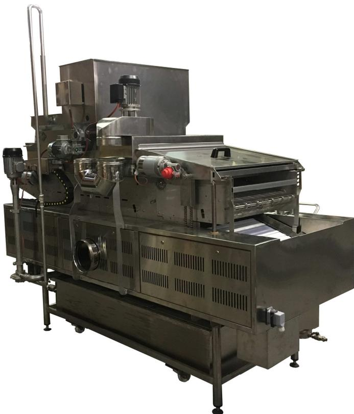
Il sistema di filtraggio assicura un'ottima pulizia dell'olio, una lunga durata ed un'estrema praticità. L'olio pompato dalla vasca della friggitrice al filtro a carta, viene filtrato da una speciale carta per alimenti (indicata per l'utilizzo fino alla temperatura di 200°C) che trattiene i residui di cottura, la farina, e le piccole particelle, lasciando passare l'olio pulito, che per caduta ritorna, a scelta, nella vasca della friggitrice o nella vasca di rabbocco dell'olio.
