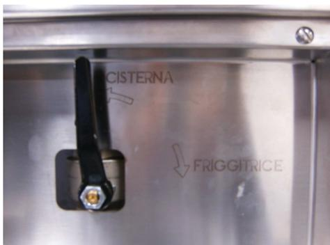
E' possibile decidere se mandare l'olio filtrato alla vasca della friggitrice o alla vasca di recupero olio (vedi immagine). Se lo si scarica nella vasca di recupero olio è possibile mantenerlo alla temperatura impostata (grazie ad un termostato regolabile) in modo da conservarlo allo stato liquido, pronto ad essere subito utilizzato.
