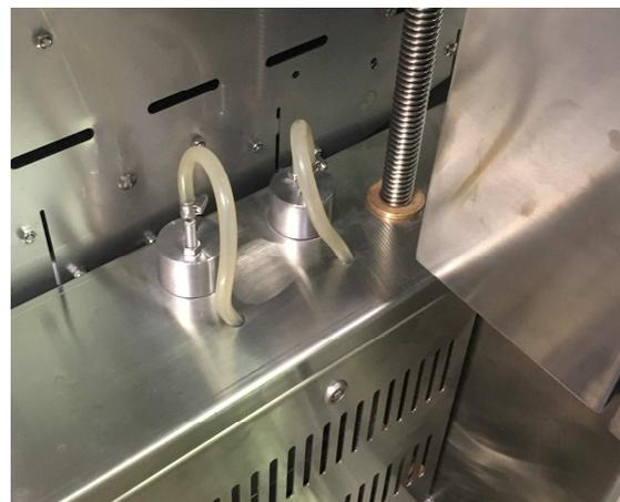
Il sistema di filtraggio assicura un'ottima pulizia dell'olio, una lunga durata ed un'estrema praticità. L'olio pompato dalla vasca della friggitrice al filtro a carta, viene filtrato da una speciale carta per alimenti (indicata per l'utilizzo fino alla temperatura di 200°C) che trattiene i residui di cottura, la farina, e le piccole particelle, lasciando passare l'olio pulito, che per caduta ritorna, a scelta, nella vasca della friggitrice o nella vasca di rabbocco dell'olio.
